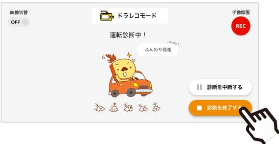
「ドラレコモード」を利用中に「手動録画」ボタンをタップすると任意のタイミングで映像を保存することが可能です。映像はタップして最大15秒後まで保存されますので、必ず車を安全な場所に停止してから操作してください。
